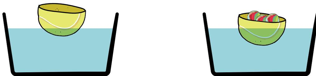
Deux balles de tennis coupées en deux vont avoir la même masse et vont flotter. Si on ajoute de la masse à l'intérieur d'une de ces demi-balles, celle-ci va s'enfoncer un peu plus, puisque son poids a augmenté. Si le poids venait à être trop élevé en fonction de la poussée exercée par l'eau, la demi-balle va couler.
